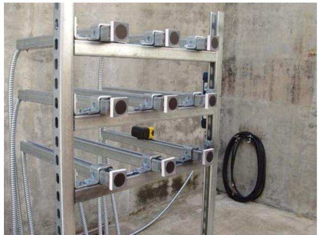
Fig. 2. Calorimeter array
