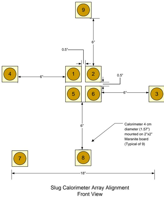
Fig. 24. Adjusted calorimeter array
